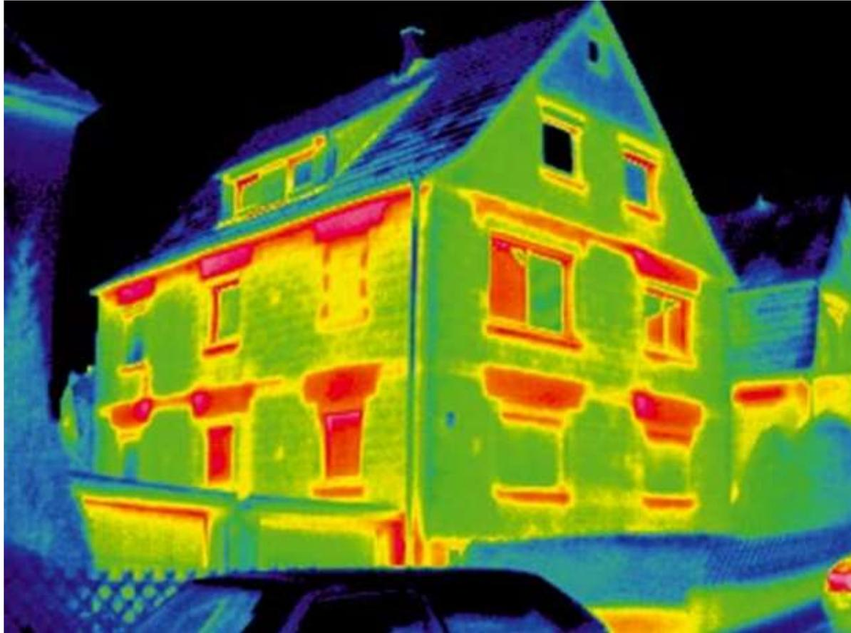
Einige Schwachstellen können durch IR – Kameras sichtbar gemacht werden!
